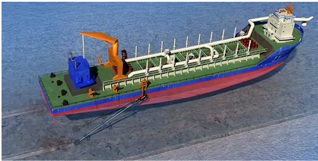
图 2.4.2-2 耙吸船施工三维示意图
