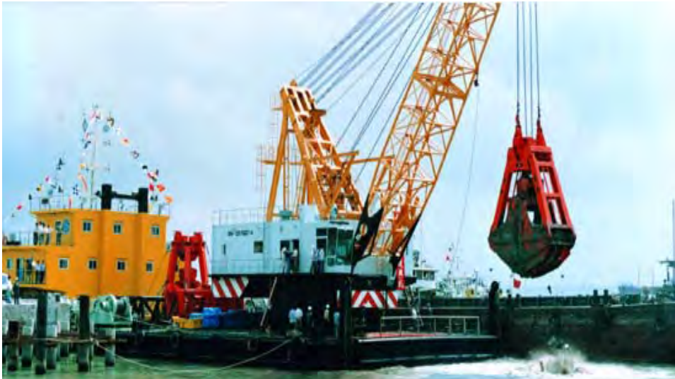
图 2.4.1-1 抓斗式挖泥船施工示意图
